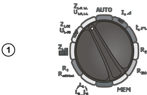
Установите поворотный переключатель в режим  $Z_{L-N,L-L}/U_{L-N,L-L}$ .
