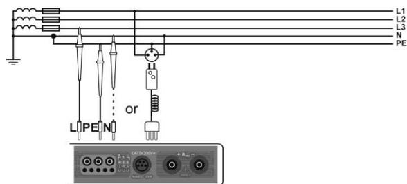
Подключите измеритель согласно схеме:
