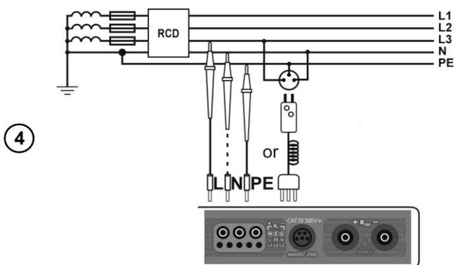
Подключите измеритель согласно схеме.
