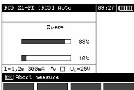
Для начала измерения нажмите клавишу **START**. Некоторые измерения могут привести к выключению УЗО. Для измерения следующих параметров достаточно привести УЗО в рабочий режим.
