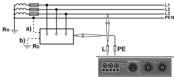
Схемы подключения для разных типов сетей:
