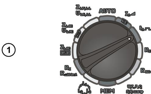
Установите поворотный переключатель в режим  $t_{A-L}$ .
