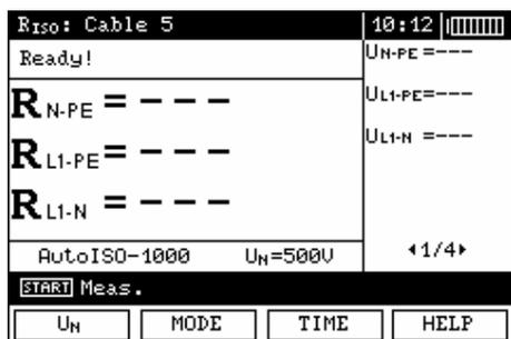
Нажмите **F1** U<sub>N</sub> для установки измерительного напряжения.
