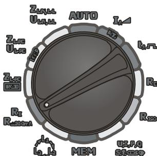
Установите поворотный переключатель в режим **R<sub>x</sub>**; **R<sub>±200mA</sub>**.
