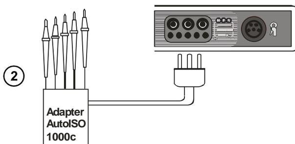
Измеритель MPI-520 автоматически определит подключение адаптера AutoISO-1000с и добавит необходимые возможности настройки.
