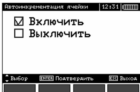
Используя клавиши ▲ ▼, выберите необходимый режим. Автоинкрементация ячеек памяти позволяет автоматически сохранять в следующую свободную ячейку памяти результаты измерений.
