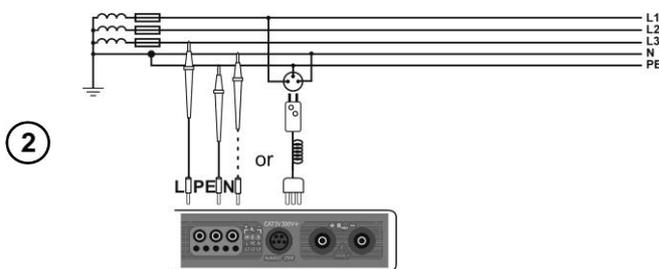
Подключите измеритель согласно схеме:
