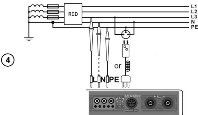
Подключите измеритель согласно схеме.
