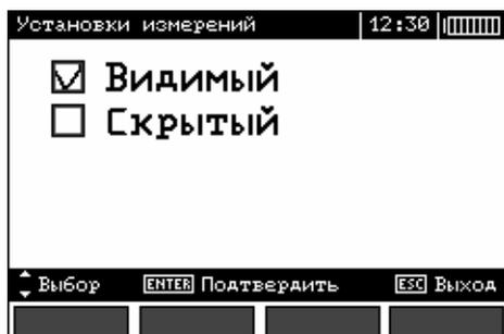
Настройка позволяет включить или выключить строку с параметрами, отображаемую на дисплее. Используя клавиши ▲ и ▼, установите необходимый вариант.
