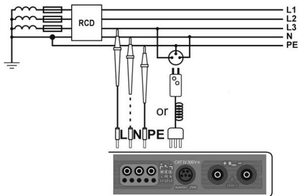
Подключите измеритель согласно схеме.
