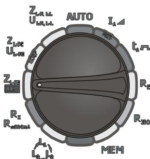
Установите поворотный переключатель в режим  $Z_{L-PE}$  **RCD**.
