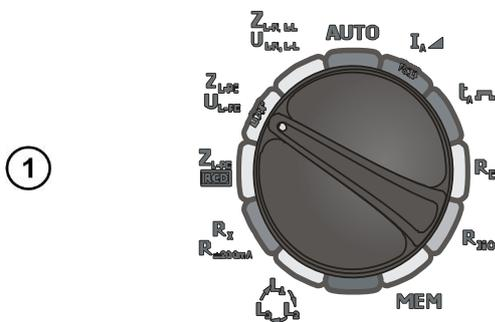
Установите поворотный переключатель в режим  $Z_{L-PE}/U_{L-PE}$ .
