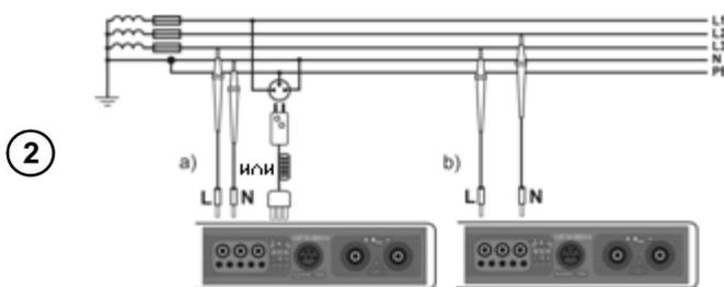
Подключите измеритель согласно схеме на следующем рисунке:
