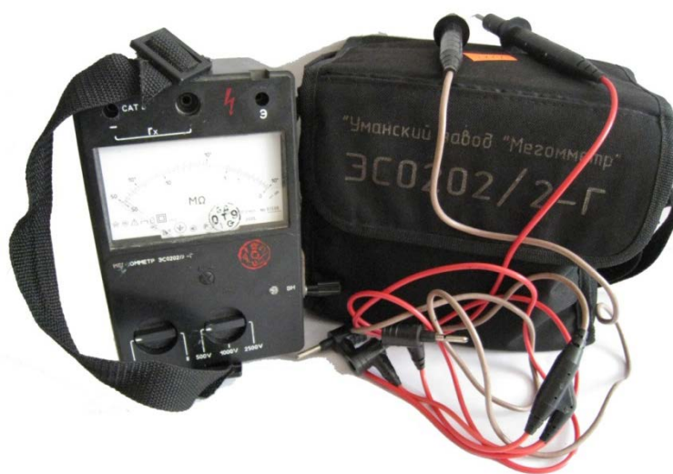
Рис. 1. Прибор для измерения сопротивления изоляции – Мегаомметр ЭСО202
