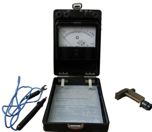
Рис. 1. Внешний вид прибора М-372
