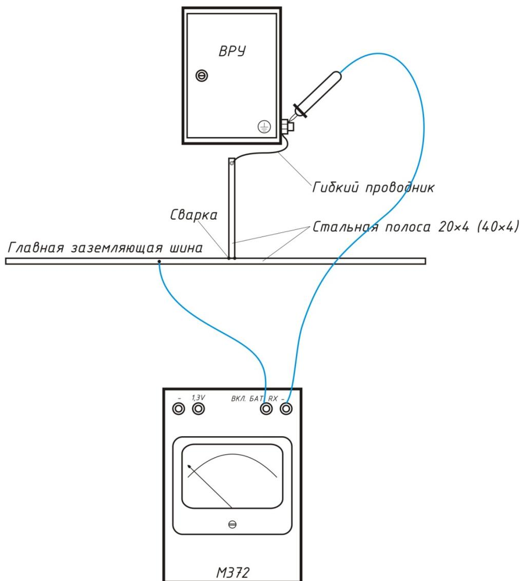
Рис. 2. Схема подключения прибора М-372 для проведения измерений
