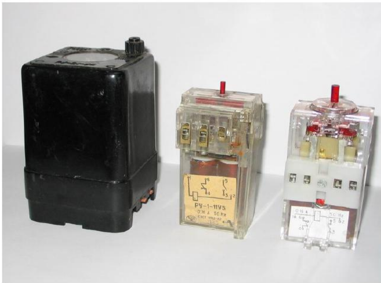
Рис. 18.1 Указательные реле. Слева направо: РY-21, РY-1, РЗУ-11.
