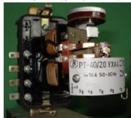
Реле серии РТ-40 (крышка условно снята)
