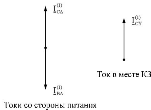
Рис. 1.9. Векторная диаграмма токов при K_C^{(1)} за трансформаторами со схемой соединения обмоток \Delta/Y -11
